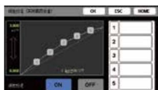
通过增加校准点改善荷重测量时的线性。可实现接近输出特性的小误差输出。(可设定5个点)
