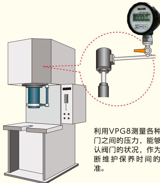
利用VPG8测量各种阀门之间的压力，能够确认阀门的状况，作为推断维护保养时间的标准。
