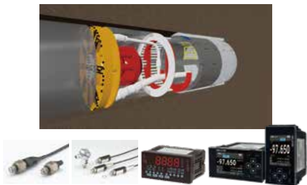
盾构机液压及泥水压监控
