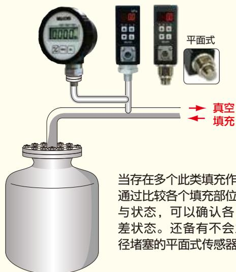
当存在多个此类填充作业时，通过比较各个填充部位的压力与状态，可以确认各自的误差状态。还备有不会发生孔径堵塞的平面式传感器。
