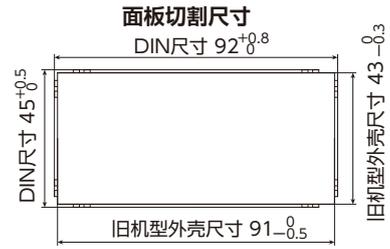
如果由旧机型 (C) VALCOLOR更新而来, 面板切割尺寸不合适时, 请削掉边缘后安装。
