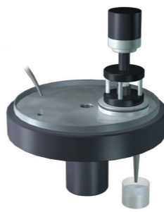
研磨機の荷重測定
