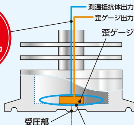
測温抵抗体の出力を3線式でダイレクトに出力
