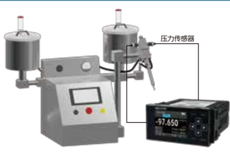
两组胶液混合时的压差控制
