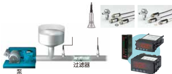
原料的压力监控
