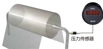
造纸领域干燥部分的蒸气压监控
