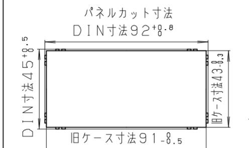
\*旧型 (C) バルカラーからの更新で、パネルカット寸法が合わない場合、ツメを削って取付ください。
