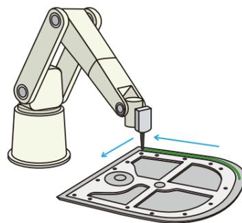
車体の強度アップやドアの外板などの接着による加工が必要な場合、接着剤の吐出圧を一定化することで接着剤の塗布幅や高さを一定化させることができ、複雑な接着パターンに対応することが可能です。
