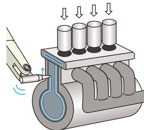
エンジンへのシリンダスレーブや各種部品の圧入力を正確に監視することで製品精度が向上し、製品の均一化を図ることができます。バルコムロードセルはロボットケーブルを標準装備しており、動きのある場所に最適です。
