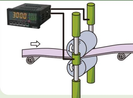
各種テンションコントロール用のロードセルをご用意しています。両側のテンションを同時に表示するF9シリーズを使用すれば、軸の左右、合計の管理が1台で可能です。環境形状に合わせたオリジナルロードセルも納期45日で製作が可能です。
