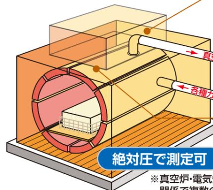
熱処理炉の炉内圧力を監視することで最適な状態での浸炭、焼結、焼鈍結果を得ることができます。ワーク素材変更や温度プロファイルの変化に追従した制御設定を行うことが可能です。
