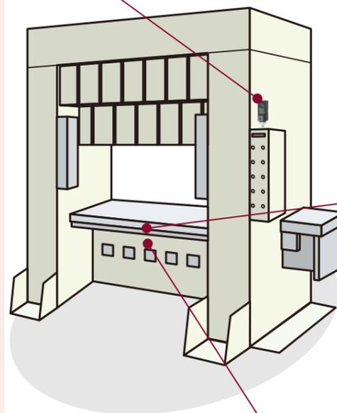
高速で動くメカプレス機のクラッチやブレーキのエア圧力制御用スイッチなどを、メカ式の目盛りダイヤルから誰でも同じ設定ができるデジタル圧力計の数値設定に変更できます。これによりベテランから新人まで同一の設定が可能です。
