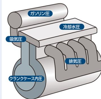
完成したエンジン単体で組み付けられた状態を確認するためテストベンチにかけますが、このとき吸気圧、排気圧、ガソリン圧力、クランクケース内圧などを計測することでピストンリングの取り付け等のチェックを行います。この検査では高速で正確に圧力を計測する必要がありますが、弊社の圧力センサは高精度・高速応答で確実な計測を実現します。
