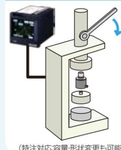
圧入機等の自動機を製作する場合、事前にワークの圧入条件を確定させるためにハンドプレスによるテストを行います。このとき、ハンドプレス用ロードセルを使用すると、容易にプレス荷重を計測でき、正確な条件出しが可能となります。
