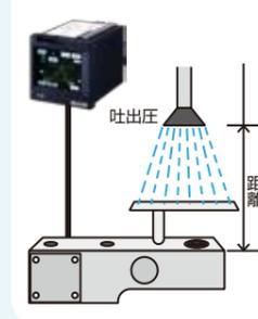
ワークの洗浄面にどのくらいの荷重=力がかかっているかを防水等級の高いロードセルを使用して、ノズル・ワークまでの距離や吐出圧力の条件を変えて計測します。
