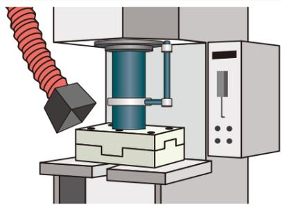
焼結プレスの場合、数回に分けて荷重を上昇させながら加熱します。このとき、加圧力を正確に制御することで成形時の成形力変化を見逃しません。これにより成形の精度UPを可能にします。
