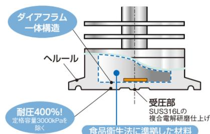
デリケートな薬液の吐出圧を計測する場合、薬液への異物混入が、大きな問題を発生させる危険があります。弊社のサニタリ式圧力センサなら封入液なしで万が一腐食で膜に穴が開いてもバーンアウトし、ライン内の汚染を最小限に防ぎます。
